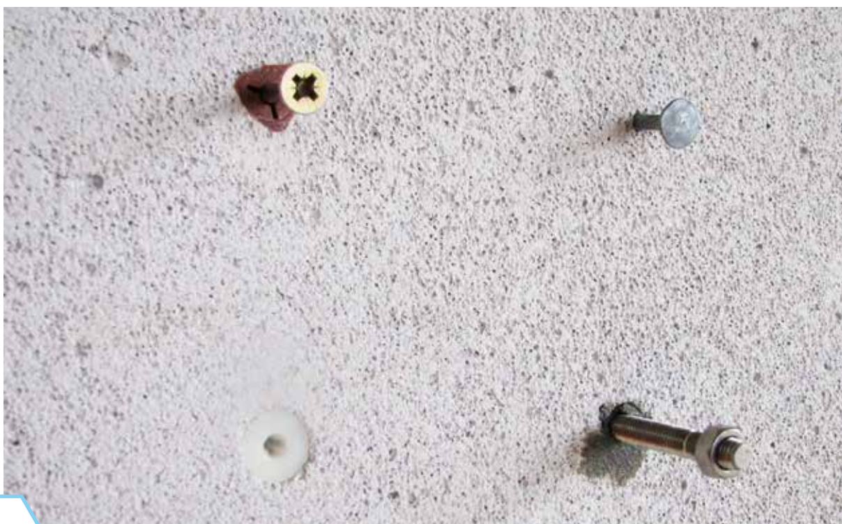
Ilustracja 43: Zamocowanie w betonie komórkowym
